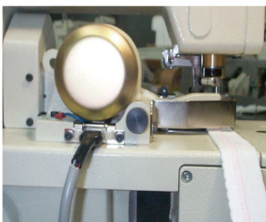
■ MC31E 電気式テープカッター for NW-F Electric tape cutter for NW-F ※旧タイプ
