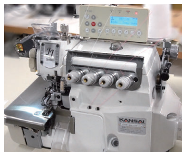
■ ATC 自動テープカット装置（センサー式）for JJ 自動、半自動で縫製前後の糸生地始末（カット）を行います。 Auto tape cutting device Automatically or semi-automatically cuts the thread fabric before and after sewing.
