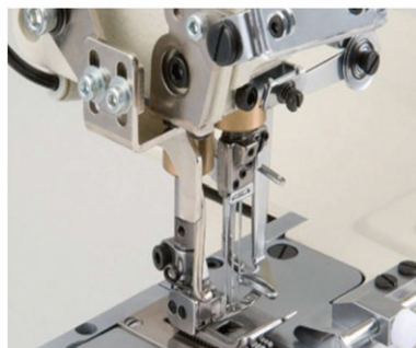
■ AW エア式上糸払い装置 (エア式ワイパー for NW,NR,NC) Air type wiper for NW, NR, NC
